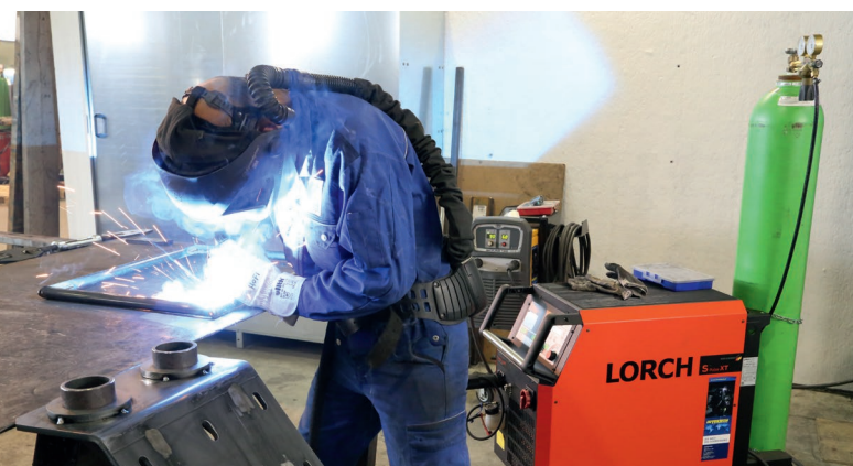
Ergonomickým tvarem a nízkou hmotností zajišťuje svařovací hořák Lorch u Powermaster MW5900 svařování bez únavy.
