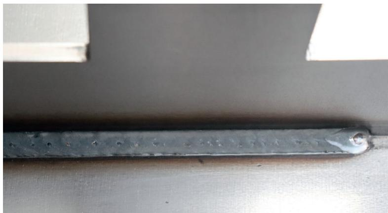
SpeedArc: Bauteile, die bisher mehrlagig geschweißt werden mussten, können jetzt mit nur einer Schweißnaht verbunden werden.
