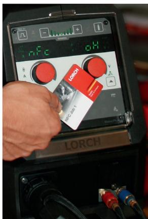
Sehr hilfreich im Fertigungsprozess: Auf NFC-Karten abgespeicherte Kennlinien können an jeder Anlage schnell und kontaktfrei eingelesen werden.
