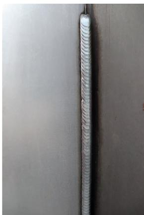
SpeedUp: Vertikale Nähte lassen sich schnell und fast spritzerfrei schweißen – ohne Spezialfertigkeiten und ohne zeitaufwändige Dreiecksbewegung.
