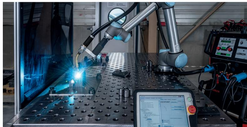
Pluspunkt der großen Armlänge des UR 10: Während der Cobot an einer Vorrichtung schweißt, kann an einer zweiten Vorrichtung auf dem Arbeitstisch bereits das nächste Werkstück eingelegt werden.
