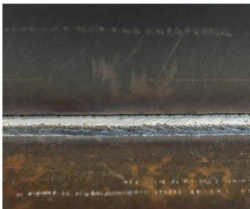
Una vista detallada lo muestra: el cordón de soldadura es absolutamente uniforme – como de manual.
