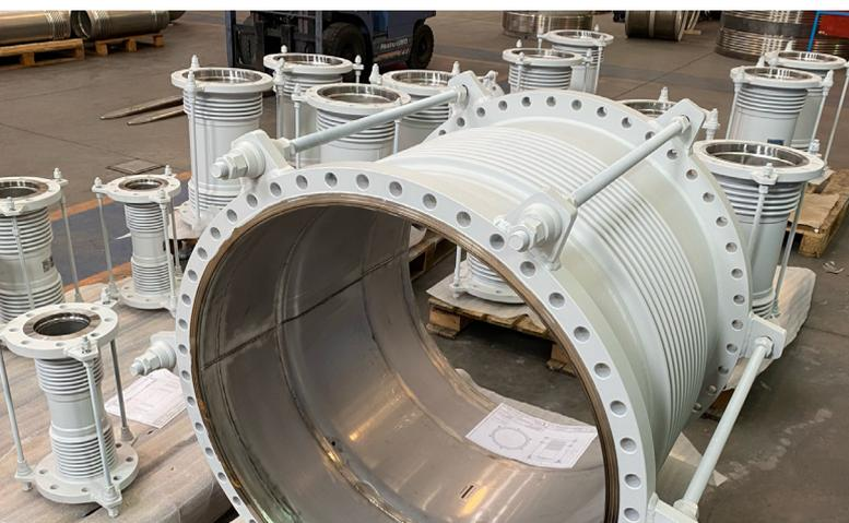
Absolument indispensables dans la construction d'installations industrielles : les joints d'expansion compensent les modifications thermiques et mécaniques des tuyauteries et doivent rester parfaitement étanches pendant tous les déplacements. Leur diamètre peut atteindre jusqu'à deux mètres.
