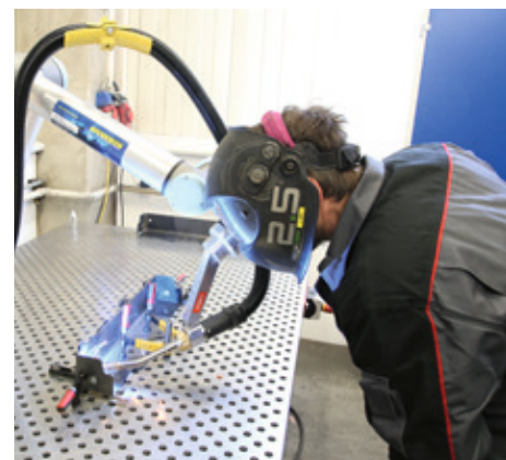
L'opérateur peut directement travailler côte à côte avec le Cobot de Lorch sans équipement de protection complexe et onéreux.
