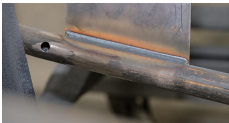
De fines plaques d'acier, dont l'épaisseur est comprise entre 1,0 et 1,6 millimètres, sont soudées au châssis de base. Le procédé de soudage SpeedCold de Lorch n'applique que la quantité d'énergie exactement requise au moment donné.
