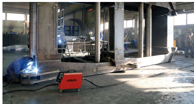
In totaal 42 lasapparaten uit de S-SpeedPulse-XT Serie van Lorch zorgen bij ADK voor uitstekende lasnaden.
