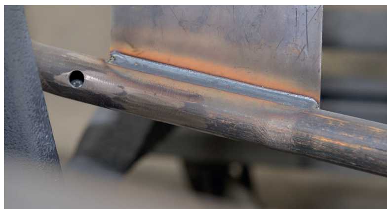
Dunne stalen platen, tussen 1,0 en 1,6 millimeter dik, worden aan het basisframe gelast. Het SpeedCold-lasproces van Lorch gebruikt slechts zoveel energie als op een gegeven moment nodig is.
