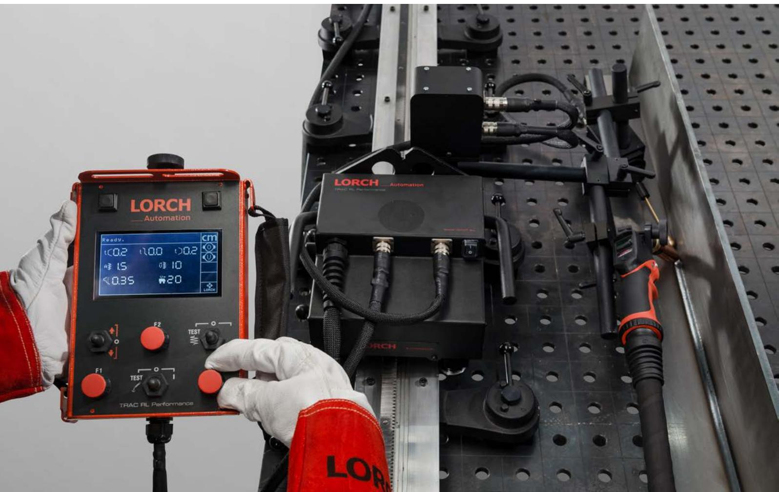
**TRAC RL Performance auf Führungsschiene mit Magnethalterung**
