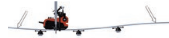
Lassen op een gebogen vlak met een flexibele geleidingsrail
