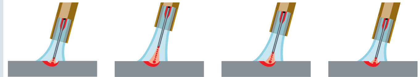
Door wijziging van de afstand van het laspistool kan de lasser beter reageren op veranderde randvoorwaarden.
