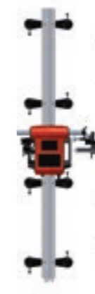
Lassen in verticale positie met geleidingsrail
