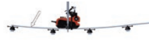
Lassen op een gebogen vlak met flexibele geleidingsrail (tank Ø vanaf 10 m)
