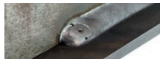
Con riempimento del cratere finale - chiusura della saldatura perfetta.
