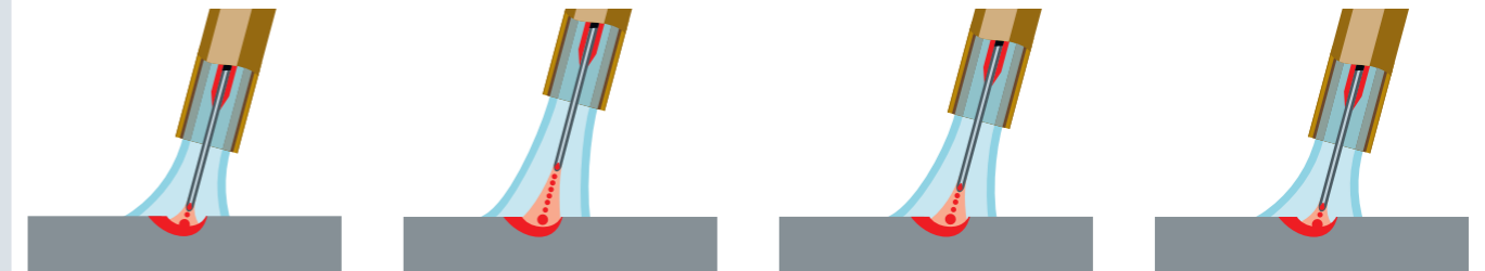
Modificando la distanza della torcia il saldatore può reagire meglio alle mutate condizioni di lavoro.
