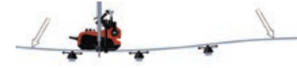
Saldatura su un piano concavo con rotaia di guida flessibile
