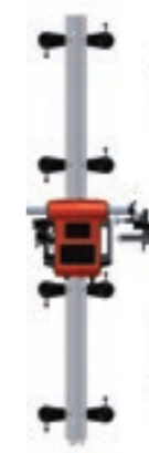
Saldatura in posizione verticale con rotaia di guida
