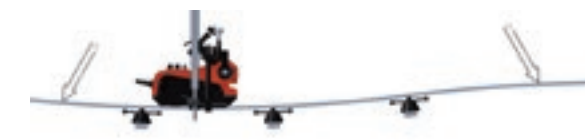
Soudage sur un plan bombé avec rail de guidage Flex
