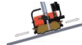
Soudage sur plans inclinés
