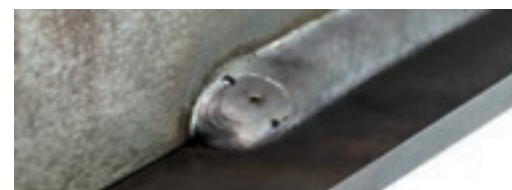
Avec remplissage de cratère final – extrémité de cordon parfaite.
