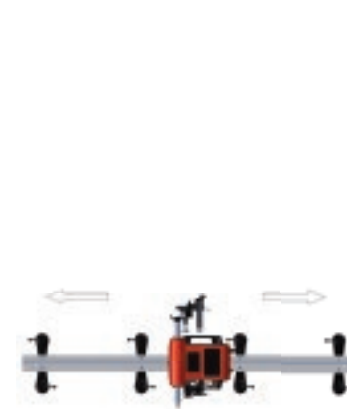
Soudage en position horizontale avec rail de guidage (avec supports magnétiques sur les côtés)
