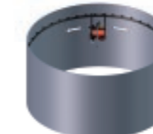
Svařování na vypouklých geometriích výrobku
