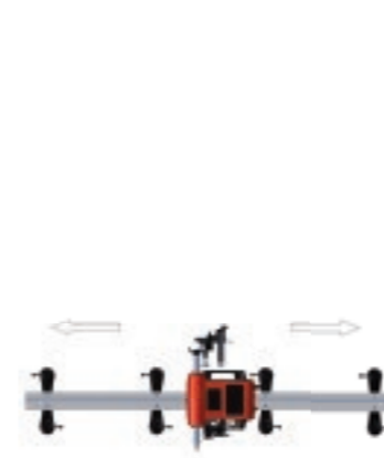
Svařování ve vodorovné pozici s vodící lištou (boční s magnetickými držáky)
