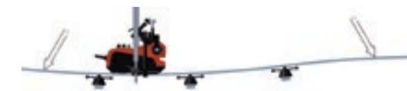
Svařování na klenuté rovině s vodící lištou Flex
