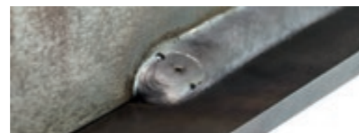
S plněním koncového kráteru – perfektní konec svaru
