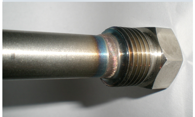
Giunzione "spesso-sottile" 5/0,7 mm
