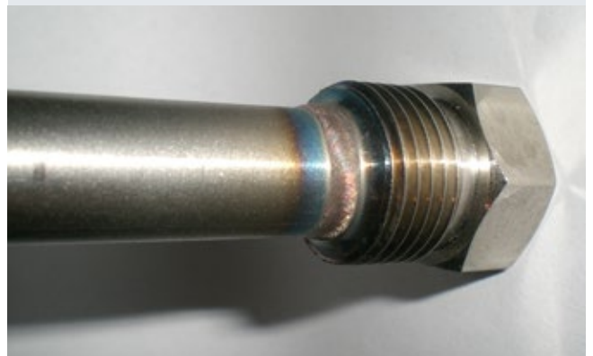
Soudure fine-épaisse 0,7/5 mm
