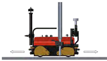
Schweißen an horizontalen Flächen
