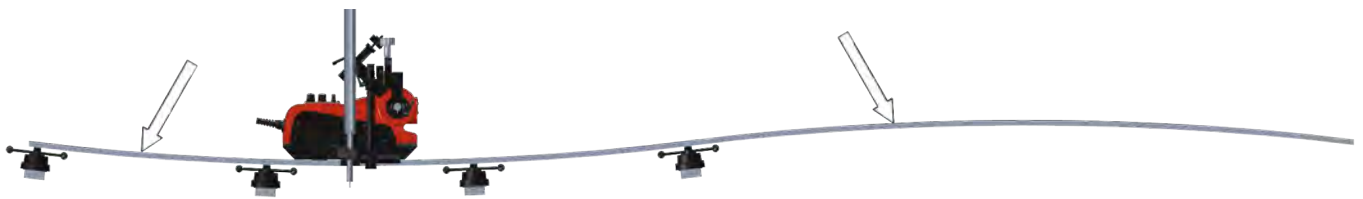
TRAC RL auf Flex-Führungsschiene montiert, Schweißen auf einer gewölbten Ebene
