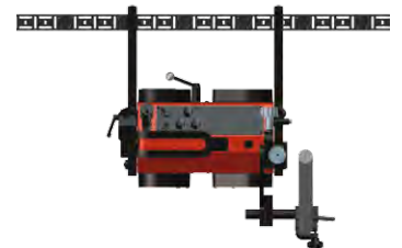
Schweißen mit Flex-Führung, Schweißbrenner neben TRAC montiert
