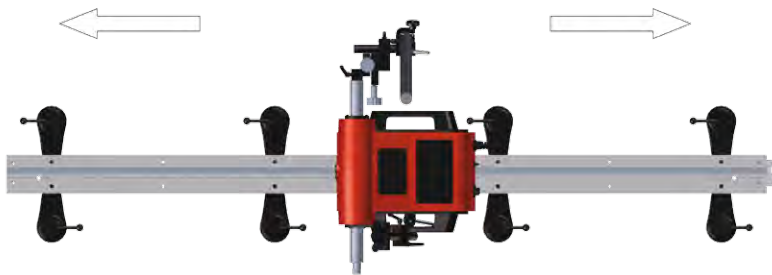
TRAC RL auf Führungsschiene, seitlich montiert (7 Magnethalterungen empfohlen)
