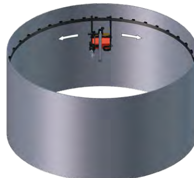
Schweißen einer konkaven Produktgeometrie
