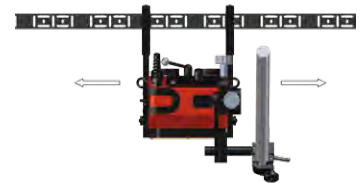
Schweißen mit Flex-Führung, Schweißbrenner neben TRAC montiert
