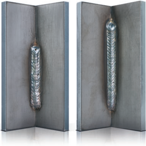
Links der anspruchsvolle „Tannenbaum“, rechts der genial einfache SpeedUp.
