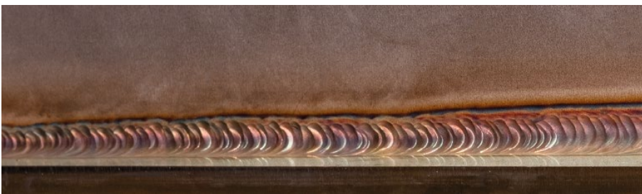
Zum Vergleich: WIG mit Zusatz Edelstahl Kehlnaht 6mm
